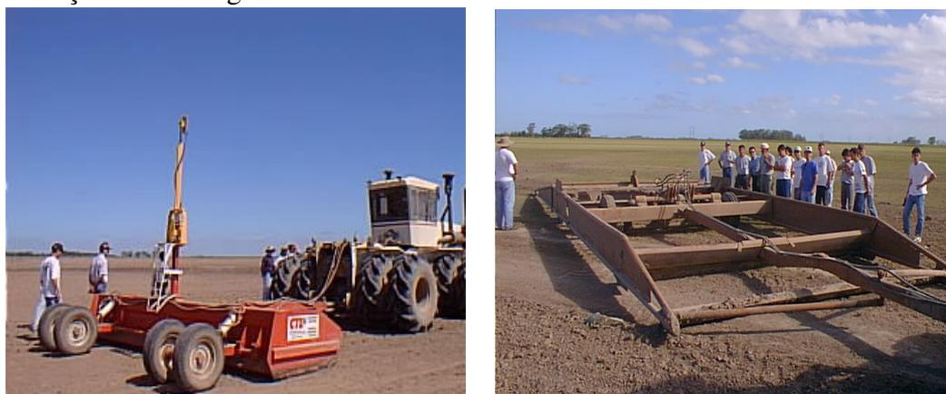
Figura 6. Sistematização do solo com auxílio de raio laser e equipamento de grande porte para desmanchar taipas utilizados na região sul do Estado)
