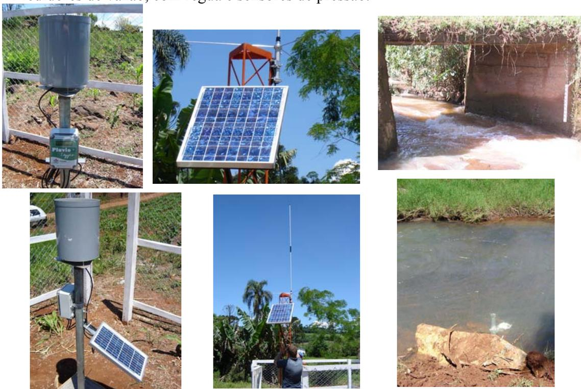
Figura 4. Imagens de equipamentos instalados nas microbacias-piloto em Santa Catarina (Pluviologger, telemetria, régua e sensores de nível do rio).
